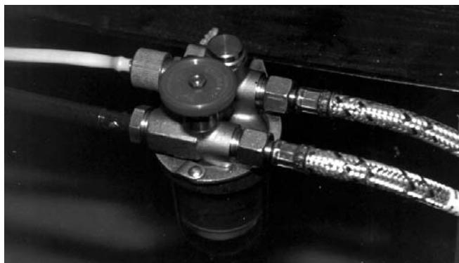
Для эксплуатации только в однолинейной системе необходимо вывинтить перепускную заглушку в отверстии обратной линии и закрыть это отверстие металлической заглушкой с уплотнением.
