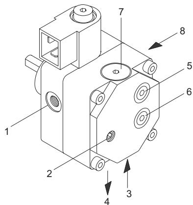
Пояснения к топливному насосу Danfoss:
