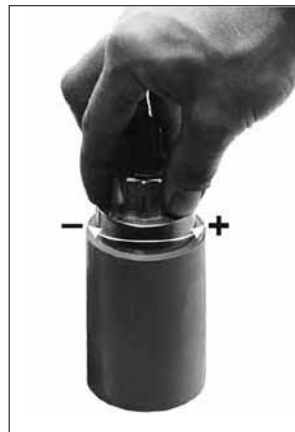
Рис.16 Регулировка главного потока MB- ZR ... B01
