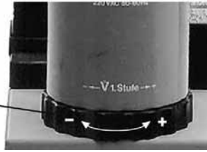
Рис.17 Регулировочное кольцо для частичного потока
