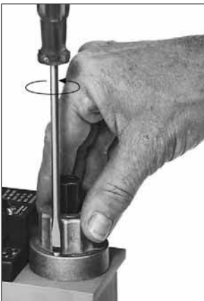
Рис.15 Регулировка главного потока MB- ... B01
